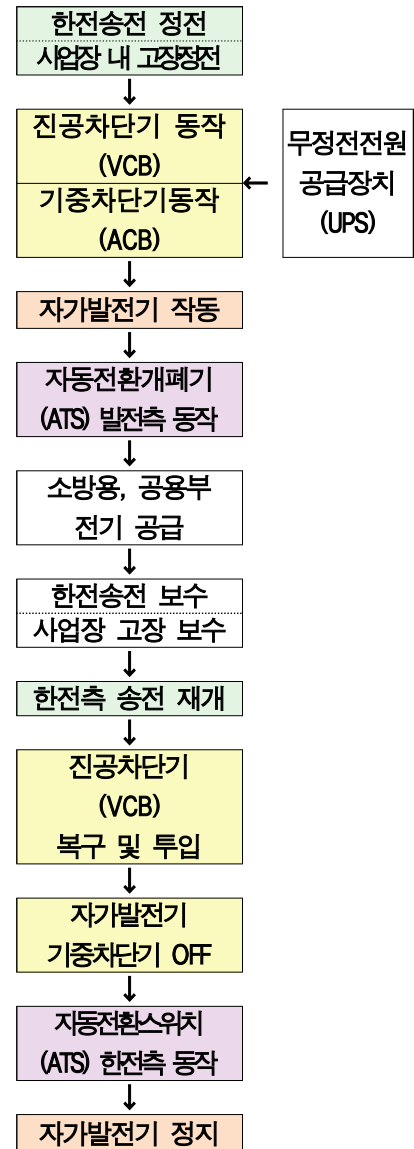
[그림 8-15] 자기발전기 동작순서도의 예
