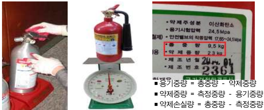
[그림 1-9] 저울을 이용한 소화기 약제량 측정 및 압력계 확인
