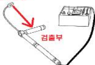
[그림 6-45] 레벨미터를 이용한 이산화탄소 약제량 측정
