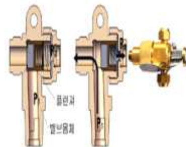
[니들밸브 동작 시 용기밸브 개방 개요도]
