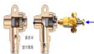
니들밸브 동작 시 용기밸브 개방 개요도
