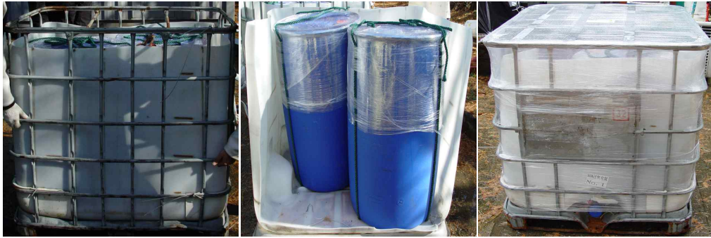
중형산적용기 내에 과산화수소 용기(플라스틱용기) 수납하기 중형산적용기 내에 과산화수소 용기를 수납한 후의 내부 사진 중형산적용기 내의 과산화수소 용기 주변에 물로 채우고 밀봉하기
