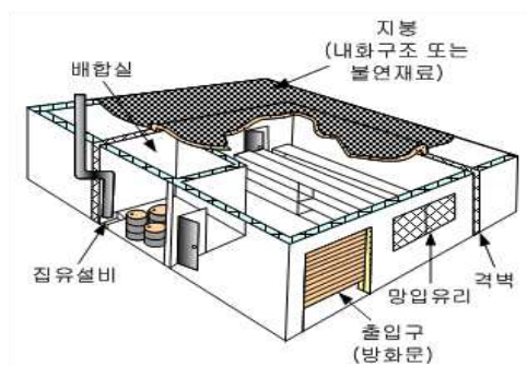
[그림 4-7] 제1종 판매취급소의 구조 [오인석 (2009), 위험물시설론, p.184]
