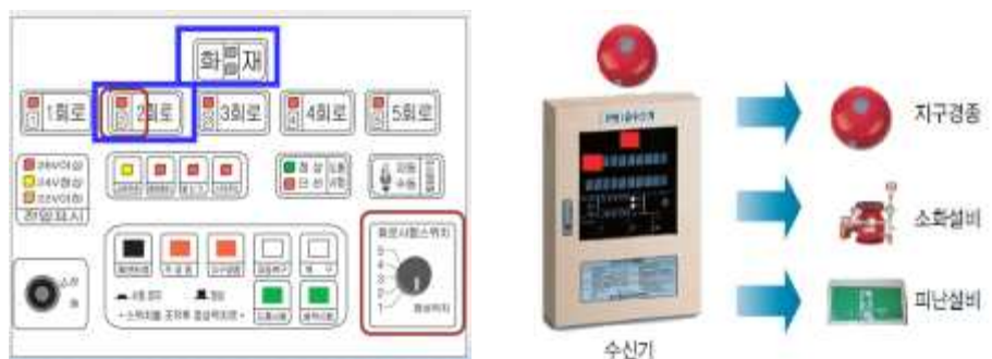
[그림 1-25] 수신기 화재 발생 표시도 및 연동동작 개요도
