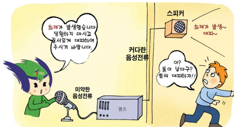
[그림 3-1] 비상방송설비의 개요도
