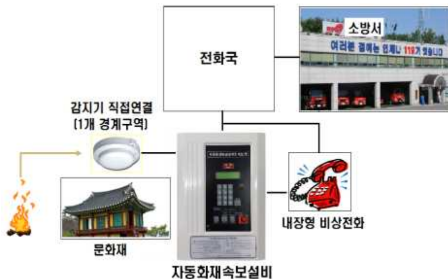
[그림 4-2] 문화재용 자동화재속보설비의 구성 개요도
