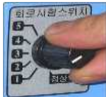
[그림 1-27] 회로선택스위치의 선택 동작 개요도
