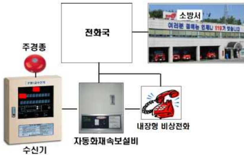
[그림 4-1] (일반형) 자동화재속보설비의 구성도
