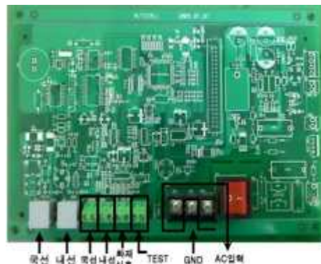
[그림 4-7] 전화선 결선 예시 1
