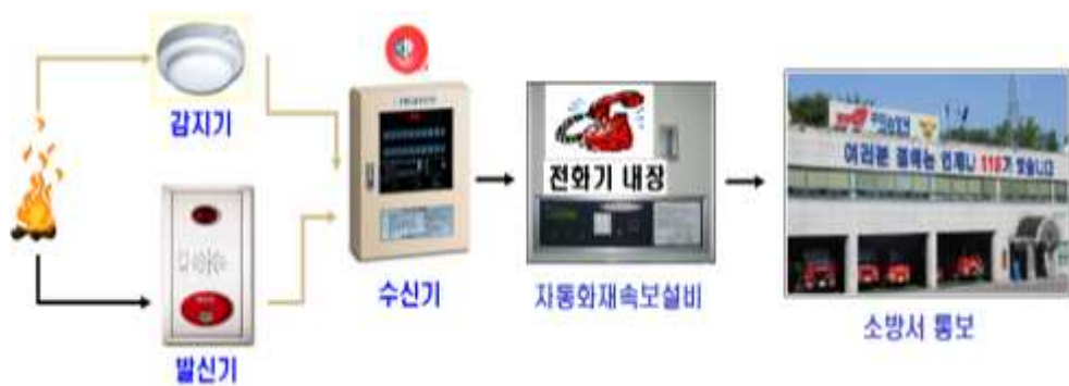
[그림 4-3] 자동화재속보설비(일반형)의 동작 개요도
