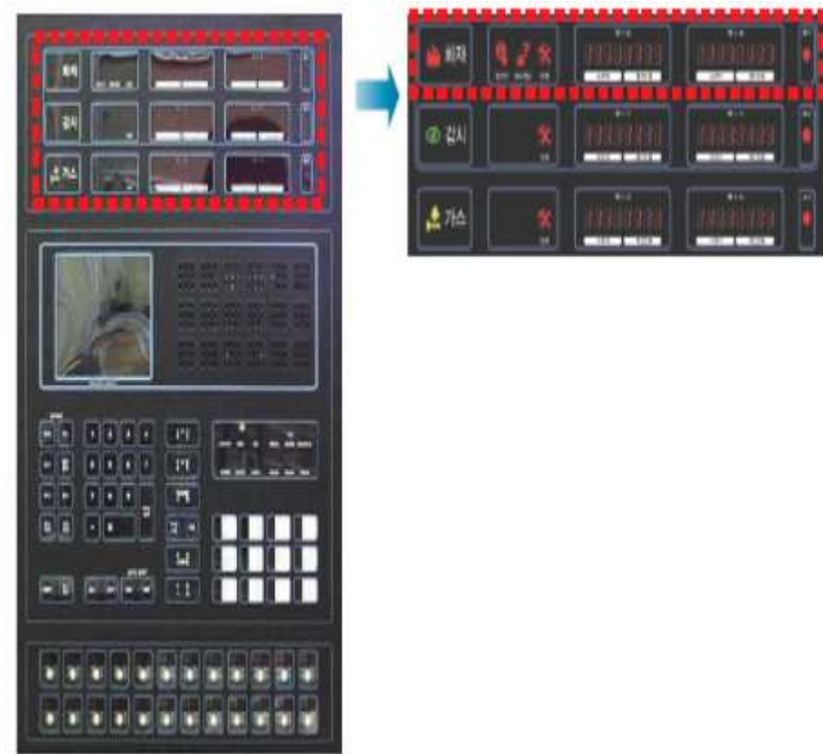
[그림 1-47] R형 수신기 화재 시 화면 표시 상태
