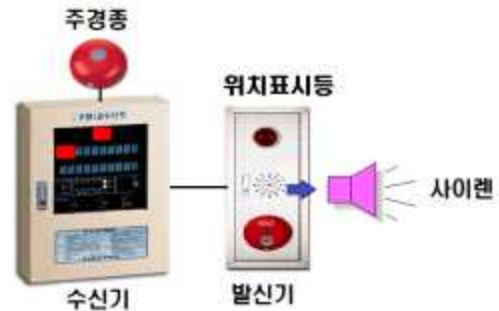
[그림 2-4] 비상경보설비 중 자동식사이렌설비의 구성도(일반적인 건물 설치 형태)
