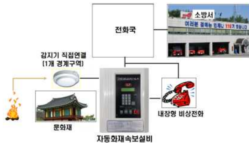
[그림 4-4] 자동화재속보설비(문화재형)의 동작 개요도
