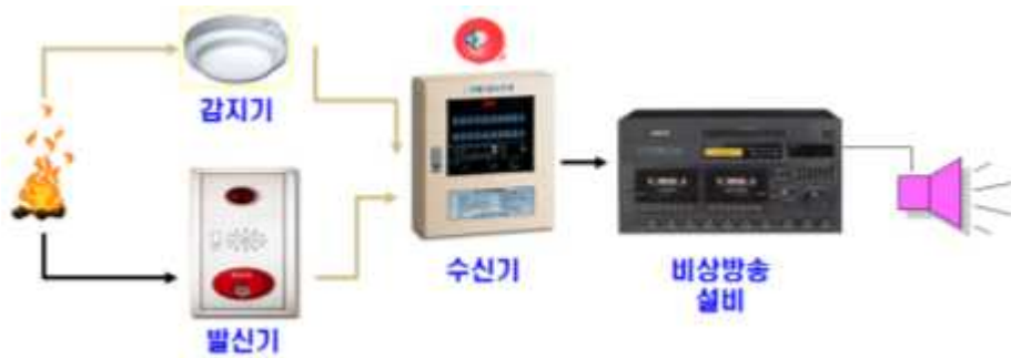
[그림 3-4] 비상방송설비의 동작 개요도의 예
