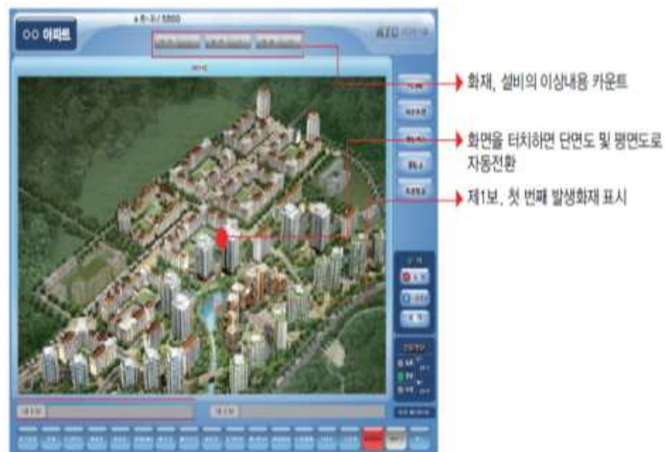
[그림 1-49] LCD 메인스크린 예시 - 평상시 상태
