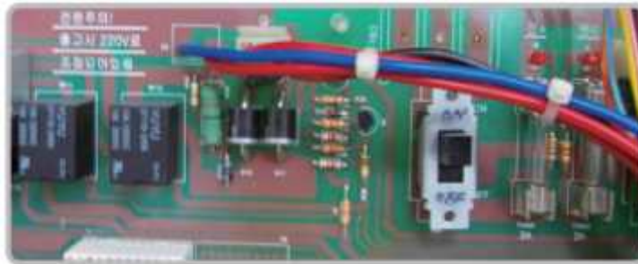
[그림 1-8] 전원스위치 및 110V/220V 절환스위치
