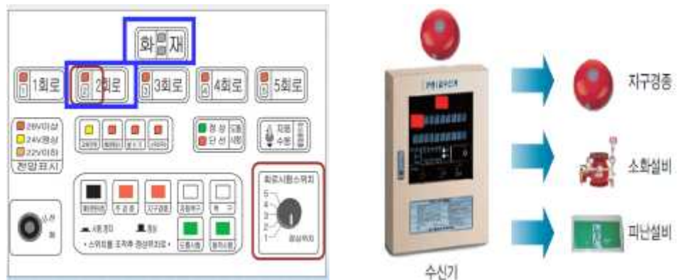
[그림 1-22] P형 수신기 동작시험 동작확인 개요도
